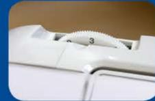
Регулятор позволяет выполнить аккуратные швы без сборок даже на самой проблемной ткани. Достаточно просто отрегулировать давление транспортера.
