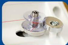
Быстрая и удобная система намотки нити на шпульку. Оберните нить вокруг шпульки несколько раз, пропустите ее через прорез и нажмите кнопку «Старт»
