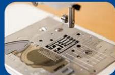
Дополнительный сегмент транспортера обеспечивает равномерное продвижение ткани. Гарантирует великолепное качество каждого стежка и гладкие, аккуратные швы на ткани любой толщины, от тонкого шелка до толстой джинсы.
